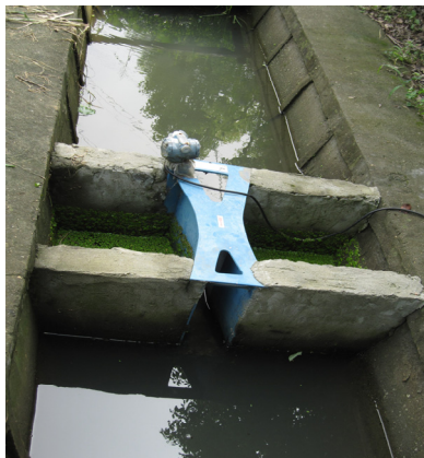
图1 排水沟中流量计
